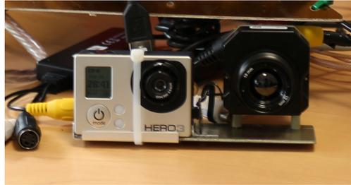
FIGURE 3.7 – Système stéréoscopique composé de la caméra GoPro 3 et de la caméra Flir Tau 2.
