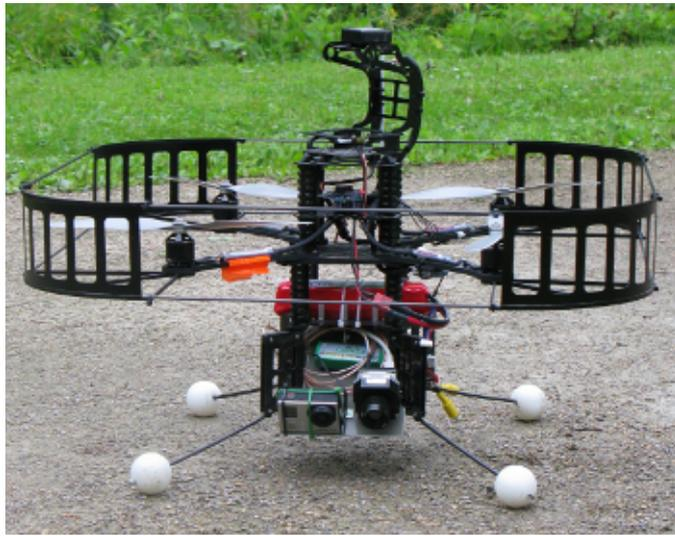
FIGURE 3.34 – Drone Pelican équipé du système d’acquisition stéréoscopique hétérogène visible / infrarouge
